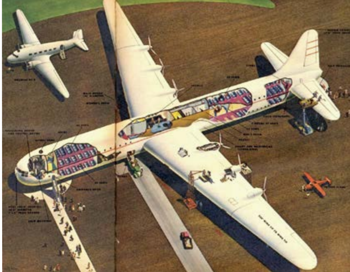
Fortune 誌に掲載された XC-99 民間型の機内構造を表したイラスト
